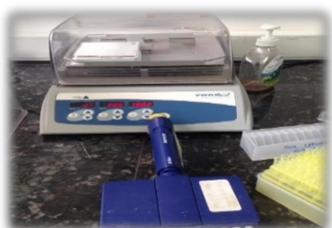
Prueba de ELISA IgM, para captura de anticuerpo e incubación de la placa de micro titulación para la prueba ELISA IgM
