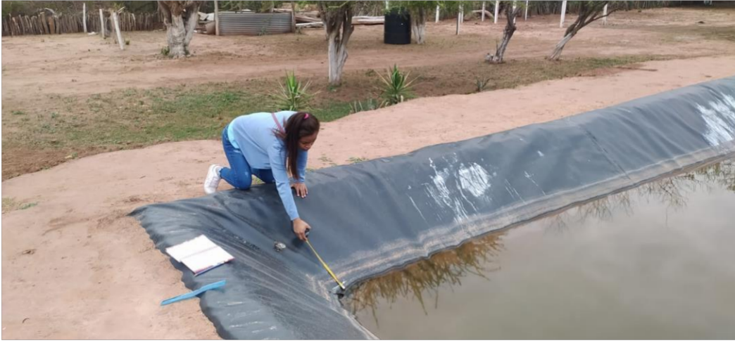
Anexo 6 Marcando las pérdidas de agua
